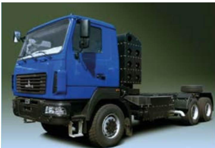
ГРУЗОВОЕ ШАССИ МАЗ-630223 (КПГ) С КОЛЕСНОЙ ФОРМУЛОЙ 6X6
