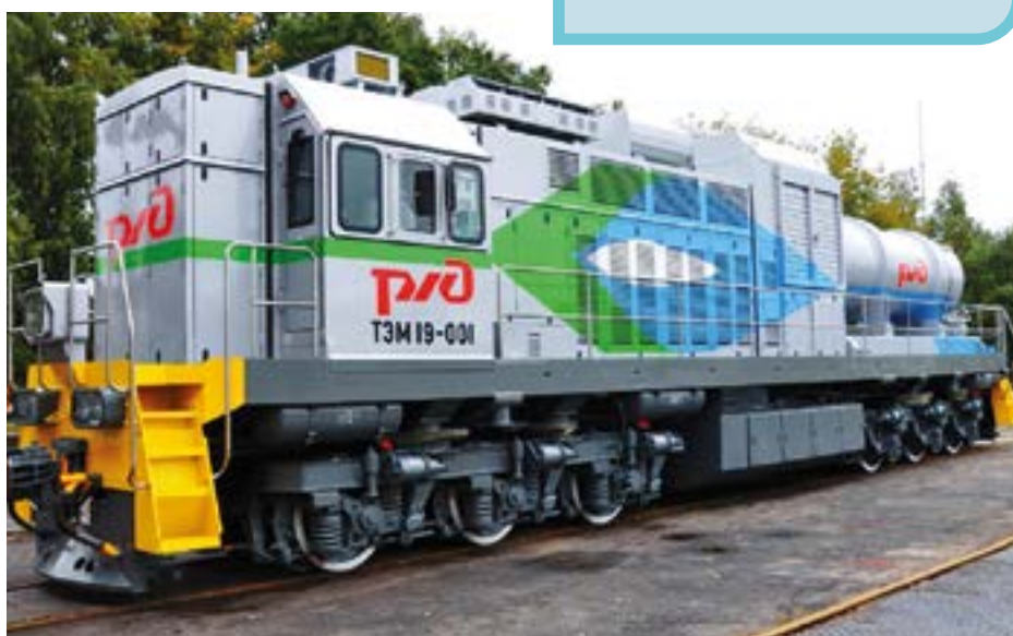
ШЕСТИОСНЫЙ МАНЕВРОВЫЙ ТЕПЛОВОЗ С ГАЗОПОРШНЕВЫМ ДВИГАТЕЛЕМ ТЭМ19 — РЕЗУЛЬТАТ СОВМЕСТНОЙ КООПЕРАЦИИ ОАО «БРЯНСКИЙ МАШИНОСТРОИТЕЛЬНЫЙ ЗАВОД», ОАО «ВОЛЖСКИЙ ДИЗЕЛЬ ИМЕНИ МАМИНЫХ», ООО «КРИОМАЗ-БАЛАШИХИНСКИЙ ЗАВОД КРИОГЕННОГО МАШИНОСТРОЕНИЯ»
