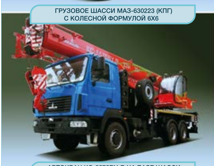
АВТОКРАН КС-5575ВУ-R НА БАЗЕ ШАССИ МАЗ-630223 (КПГ) С КОЛЕСНОЙ ФОРМУЛОЙ 6X6
