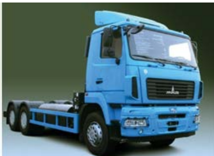
ГРУЗОВОЕ ШАССИ МАЗ-631223 (КПГ) С КОЛЕСНОЙ ФОРМУЛОЙ 6X4
